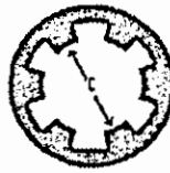
مقطع ماسورة سلاح حربي يظهر شكل الميازيب
