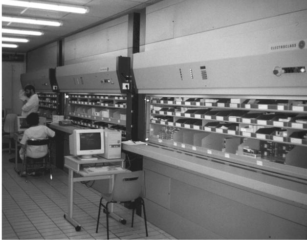
Figure 3.23 – Stockage rotatif ([www.hanel.de](http://www.hanel.de))
