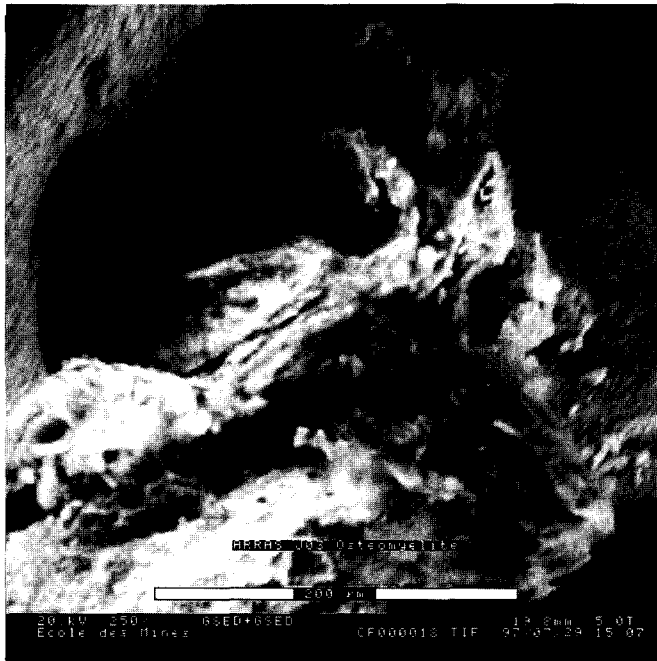
Fig. 5.19. Observation de la surface d'un os à l'aide d'un microscope environnemental. L'échantillon n'a subi aucune préparation ni étuvage préalables ; l'image en électrons secondaires est réalisée sous une pression partielle de 600 Pa de vapeur d'eau. Les conditions d'observation se prêtent bien à la réalisation de cartes de répartition des éléments chimiques à l'aide d'un détecteur Si(Li) (Document aimablement communiqué par J. Dürr – École des Mines de Douai).
