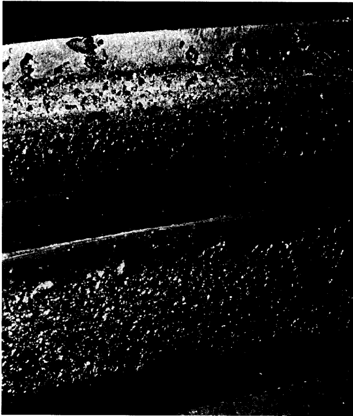
Fig. 3.30. Piqûration sur dents d'engrenage.
