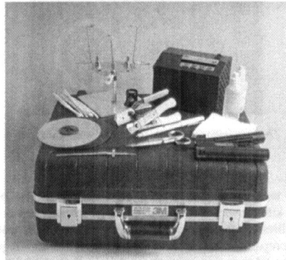
الشكل 6-34 عدة ربط الليف بالغراء. عبر تذويب الغراء من خلال التسخين (تقدمة (AURIGA (europe) PLC
