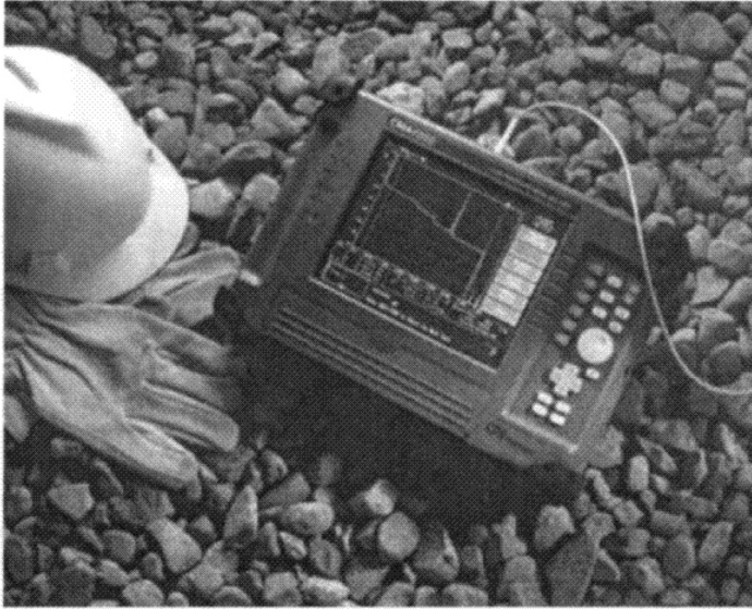
الشكل 11-8 مقياس (OTDR) متنقل، نموذج سي أم أي 4000 (CMA4000) للاستعمال الميداني (تقدمة شركة نت تست)
