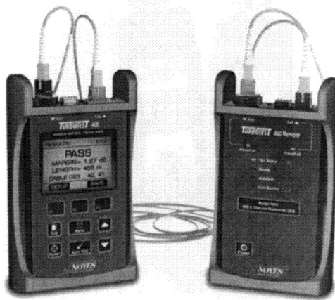
الشكل 5-8 جهاز تيربوتست 400 (Turbotest 400) (تقدمة من نوينس)
