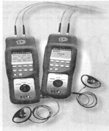
الشكل 8-6 جهاز الفيبرميتر، منظومة تصديق الفحص الميداني (تقدمة شركة داتا كوم).
