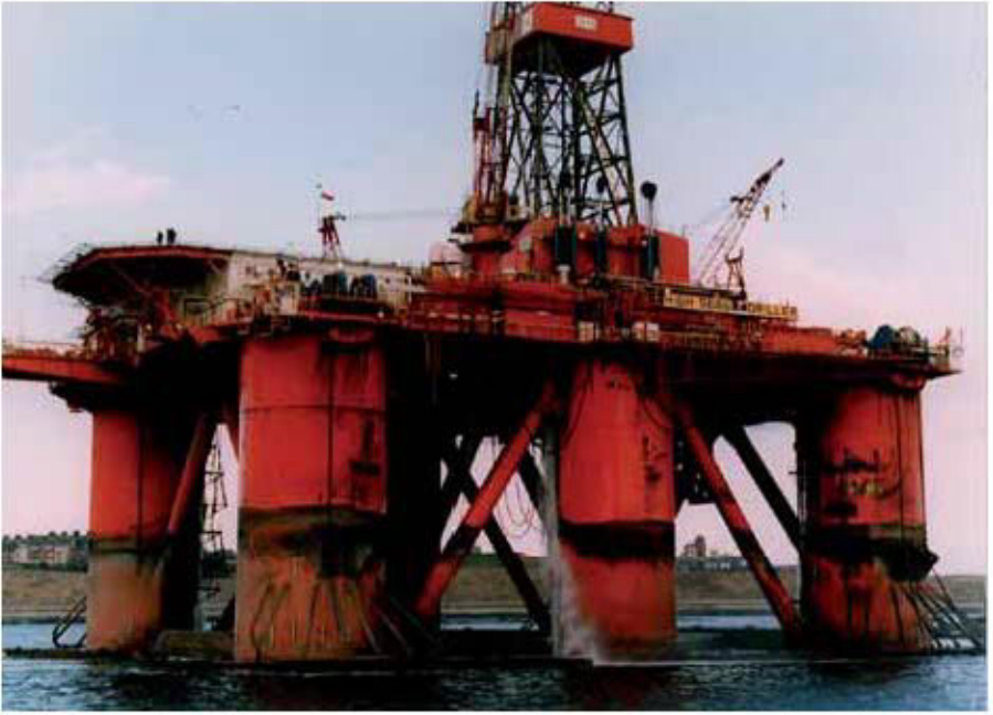
الشكل (4 - 3) : منصّات نصف - قابلة للغطس. (يُؤخذ من ستينا دريلينغ Stena Drilling)
