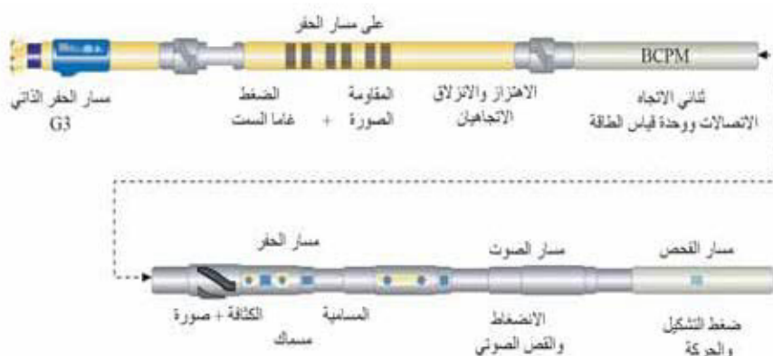
الشكل (6 - 38): أداة التسجيل البثري بتاكومبو (Pentacombo) صنع بيكو - هيوز.
