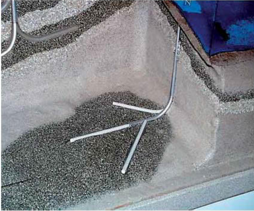
الشكل (4 - 20): نموذج لبئر متعددة الاتجاهات الجانبية لزيادة تماس الخزّان.
