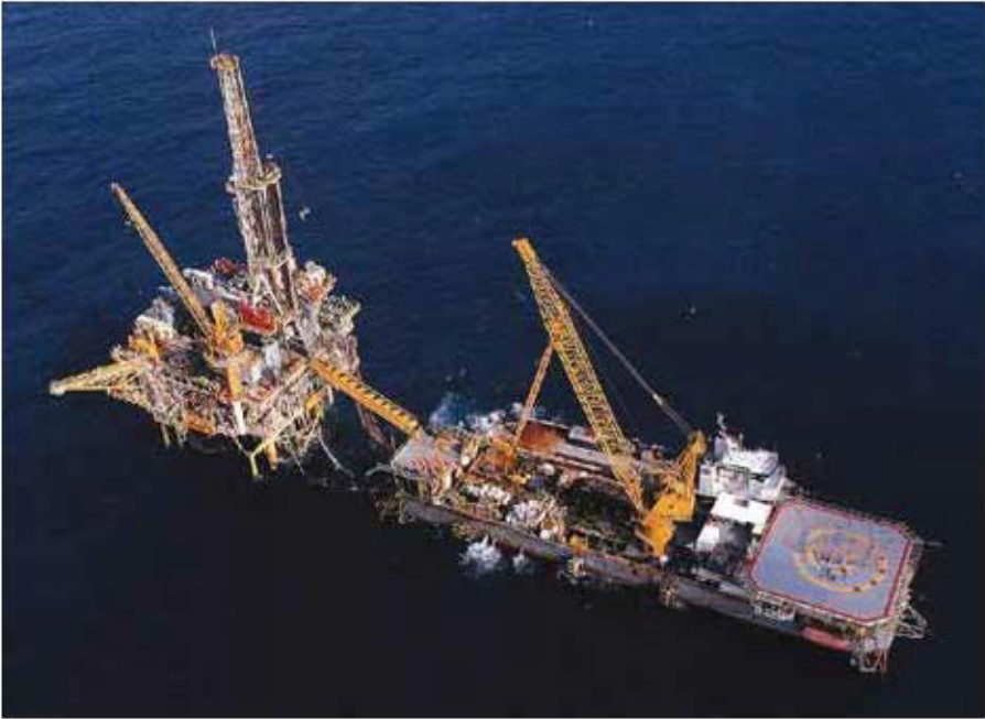
الشكل (4 - 5) : الحفر المصحوب بمقطورة تموين.
