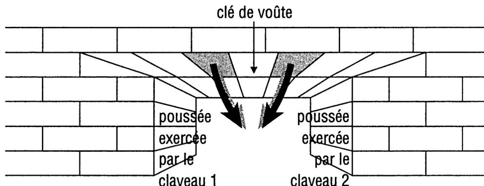
Pour une telle construction, il n'est évidemment pas raisonnable d'utiliser des pierres taillées à angles droits, même fixées à l'aide de mortier. L'idée consiste à tailler chaque claveau selon un angle tel qu'il repose en partie sur celui qui lui est adjacent, la *clé de voûte* étant le claveau central équilibrant les poussées exercées des deux côtés.
