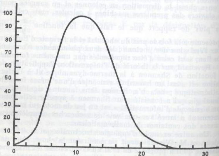
l'autre est la transmission d'une impulsion électrique dans un filtre représentée par la courbe donnée par Gabor, et qui, ramenée aux mêmes échelles que celle de la fig. 3, a presque la même forme.
