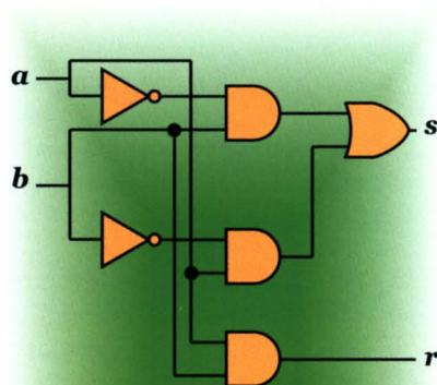
**Additionneur un bit (avec retenue)**
