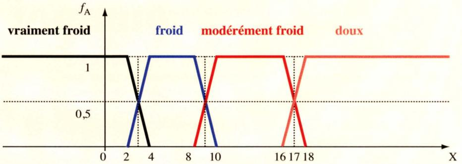
Figure 1 : Exemple de sous-ensembles flous décrivant la température
