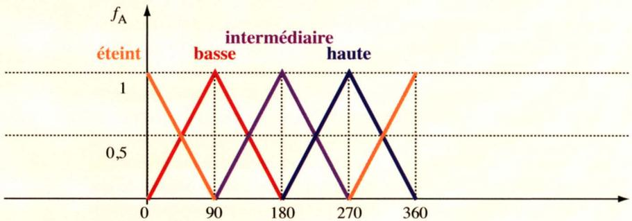
Figure 3 : Exemple de sous-ensembles flous décrivant la position du sélecteur de puissance
