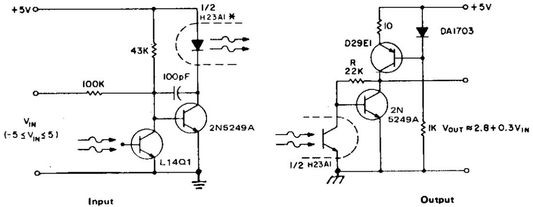
LINEAR OPTICAL COUPLER CIRCUIT
