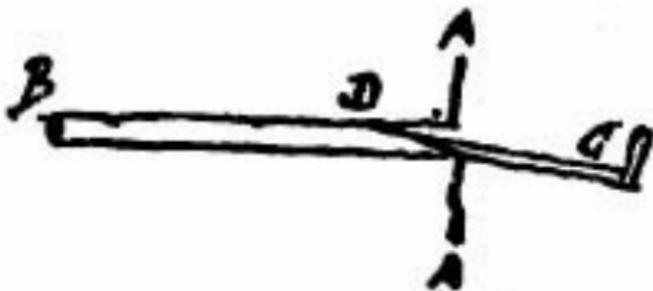
« AA représente le mur ; B le fond du trou. En posant le clou à crochet dans la position inclinée, D s'appuyait contre le haut du trou, le clou touchait la saillie du mur, et, en pesant sur le point C à l'angle formé par le crochet, le clou tenait fortement. Or, c'était en C que se trouvait nécessairement l'anneau de la cage qui maintenait le clou.
