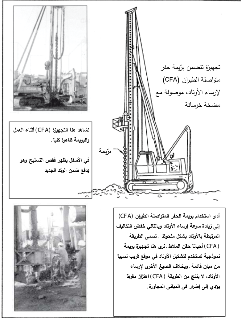
الشكل 22.4 إرساء أوتاد باستخدام بريْمَة الحفر متواصلة الطيران
