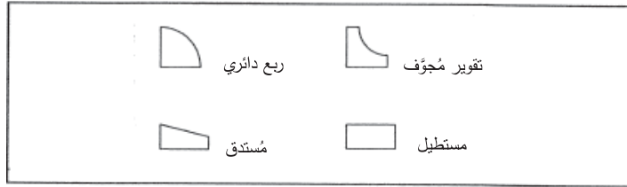
الشكل 11.11 أشكال المقاطع الخشبية لإحكام تثبيت رُقعة
