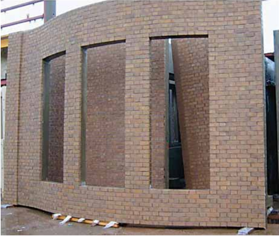
(الشكل 23.1) أشغال آجر مسبق التجميع. الصورة بإذن (Trent Concrete Ltd.).
