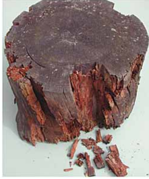
(الشكل 21.4) تدهور خشب النسغ يوضح الديمومة النسبية التي يتفوق بها القلب (خشب القلب) على خشب النسغ.
