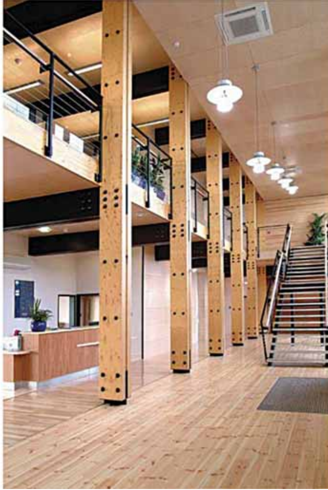
(الشكل 30.4) بناء من خشب صفائحي قشري (Finnforest Office, Boston, Lincolnshire).
