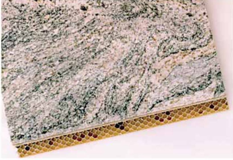
(الشكل 18.9) ألواح الإكساء الحجري الصفائحي القشري الخفيف الوزن الصورة من IP 10/01 أعيد إنتاجها بموافقة من BRE.
