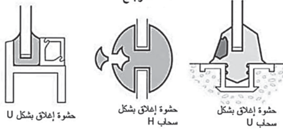
(الشكل 4.14) حشوات الإغلاق النموذجية لأنظمة الزجاج والإكساء الصفائحي.
