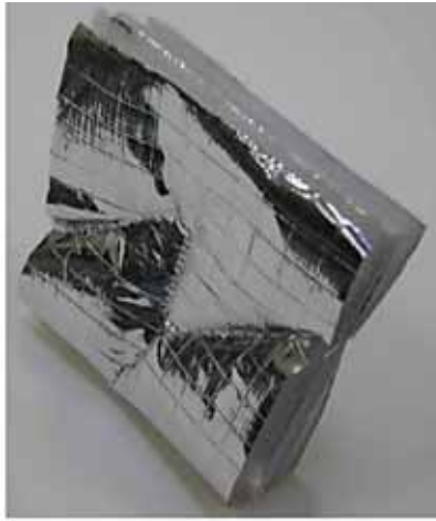
(الشكل 4.13) نظام عزل برقائق الألومنيوم متعددة الطبقات.
