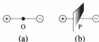
Figure 2.10 - Transformation d'une masse magnétique ponctuelle (a) par une symétrie par rapport à un centre (b) par une symétrie par rapport à un plan
