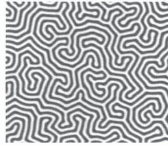
Figure 5.18 - Structure en domaines visualisée par effet Faraday dans une couche de grenat magnétique (largeur des bandes \sim 5 \mu\text{m} )
