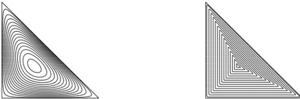
Figure 6.4 – Lignes de niveau de deux fonctions bulle sur le triangle de référence.
