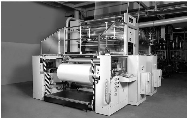
Figure 4.16 – Enrouleur de film Reifenhäuser.
