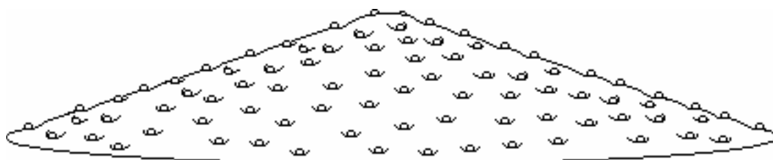
Le "château de sable" : chaque bille, dans sa cuvette, représente un atome d'uranium 235
