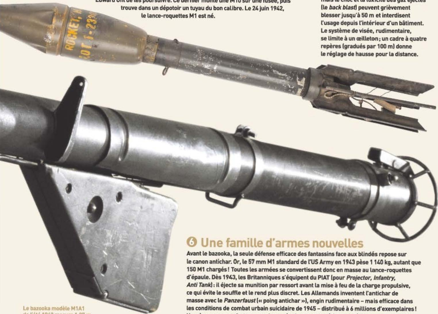
Le bazooka modèle M1A1 de l'été 1943 mesure 1,37 m de long, pèse 5,8 kg et porte (en principe) à 300 m. La cadence de tir est de cinq coups par minute. La roquette M6A1 pèse 1,6 kg et perce 90 mm de blindage. Le grillage à l'avant du tube protège (fort mal) le tireur du souffle.
