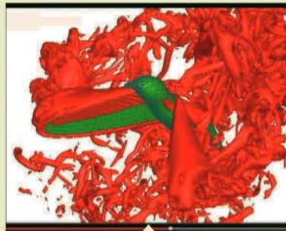
Modèle des turbulences créées par le vol du colibri.
