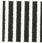
Pour le réglage en coin d'air, les interférences créées par une **source ponctuelle monochromatique** sont **non localisées**. Les interférences créées par une **source étendue** placée à l'infini, sont **localisées au voisinage du coin** (à l'intersection de deux émergents issus d'un même incident).
