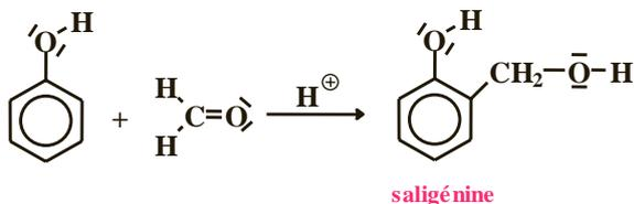
Dans cette réaction, l'acide ( $\text{H}_2\text{SO}_4$ ,  $\text{H}_3\text{PO}_4$ ...) permet de former le carbocation à partir du méthanal. Le carbocation ainsi formé réagit sur le phénol par une substitution électrophile sur aromatique SE2 :
