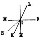
point I sur une surface réfringente plane MN, on obtient la direction du rayon réfracté en menant au point I la normale IH, en prolongeant IL dans le nouveau milieu; et la direction IR, qui fait avec LK un angle égal à celui de IK avec la normale, est la direction du rayon réfracté.
