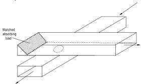
Figure C48 Waveguide (Bethe) coupler.
