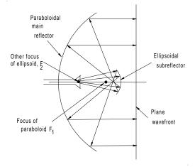
Figure A57 Dual-reflector Gregorian antenna.
