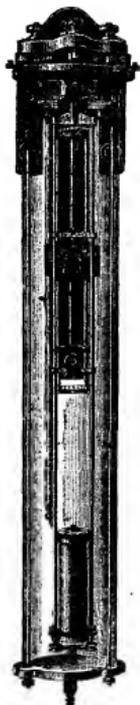
FIG. 30.—Hipp Electrical Clock (Peyer, Favarger et Cie.).
