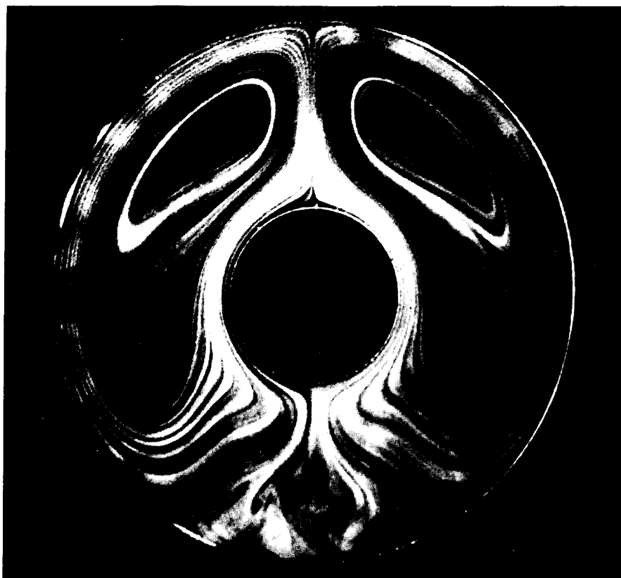
fig. 2 - Expérience de Bénard : fumée de cigarette entre deux cylindres en rotation (O.N.É.R.A.).
